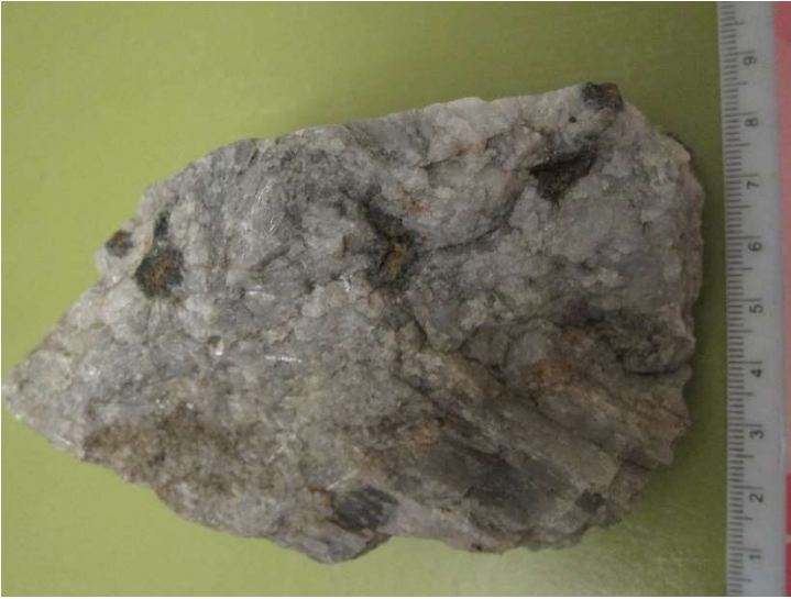
Fig. 5. Ej identifierade fosfatnoder, omringade av en turmalinkant, i cleavelandit.
