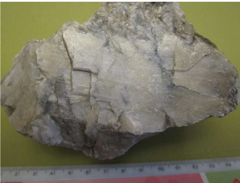
Fig 4. Spodumen. Notera den blockiga kristallformen, typisk för pyroxener.
